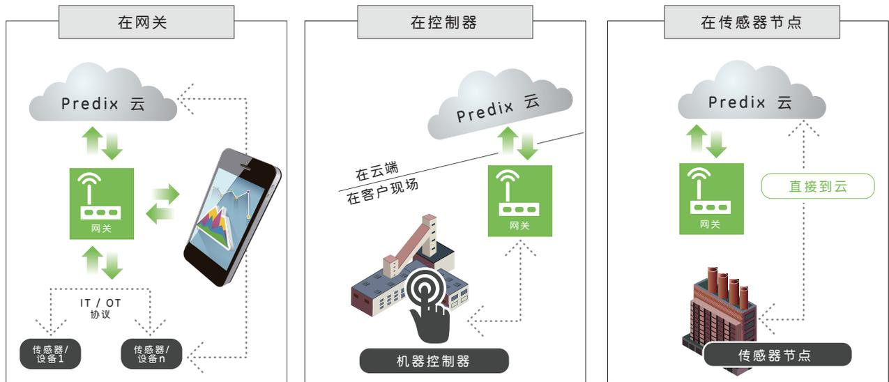
网关在云和机器之间承担着智能导管的作用，通过各种IT或OT协议提供到资产连接。
